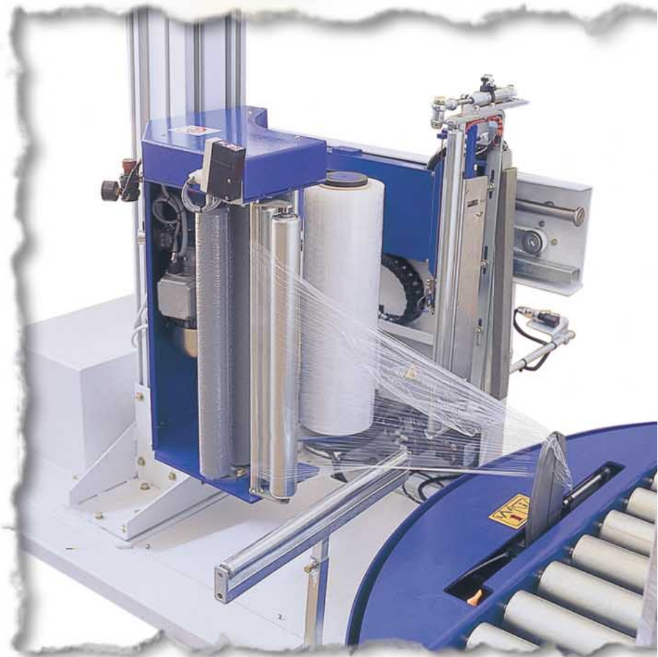
Mettifoglio automatico Automatic sheet insertion device
