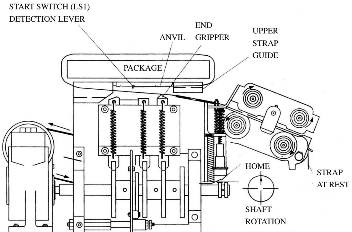
FIGURE 14. ENCIRCLING PACKAGE; TRIPPING LS1
