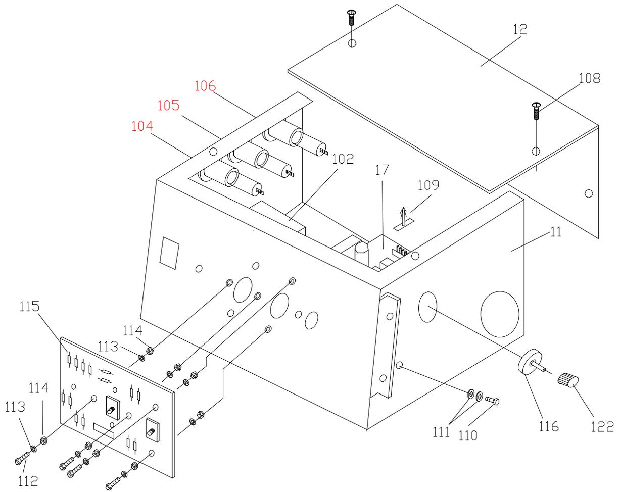
FIGURE 10-2. CONTROL BOX ASSEMBLY
